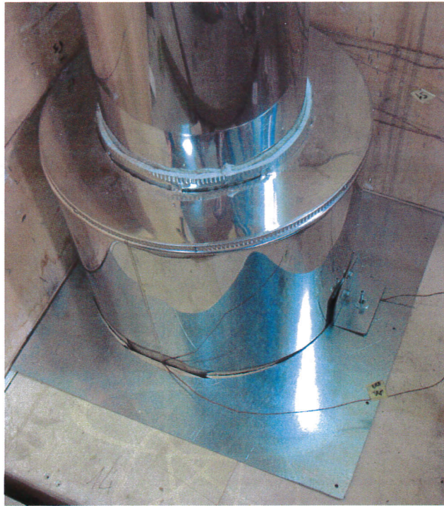
Piano superiore (con lamiera e corda fibraceramica)
